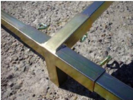
alle Winkel mit der glatten Seite nach außen und mit der schrägen Schweißnaht nach oben, dann Giebel für Giebel das Dachgerüst zusammenstecken....
